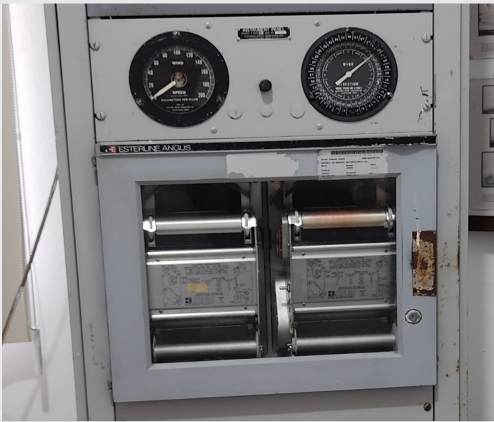
Figura 1. Equipo de medición Modelo F-420C-M4 de la marca ESTERLINE ANGUS Fuente: Observatorio Meteorológico 76692 Boca del Río, Ver.
